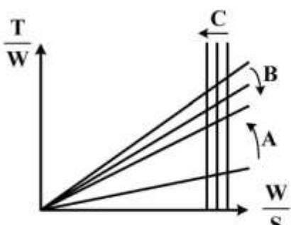
۱) افزایش مسافت برخاست، B افزایش  $C_{l_{max,L}}$ ، C کاهش  $C_{l_{max,T_0}}$
