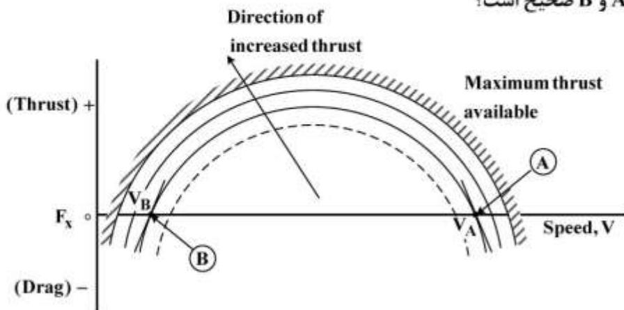
(۱) در نقطه A هواپیما دارای سرعت تعادلی پایدار و در نقطه B دارای سرعت تعادلی ناپایدار می‌باشد.
