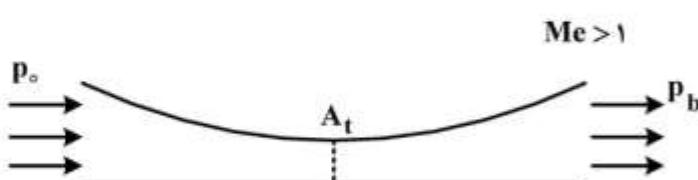
۱) در صفحه خروجی نازل موج ضربهای مایل رخ داده و نازل در حالت عملکرد over-expanded قرار می‌گیرد.
